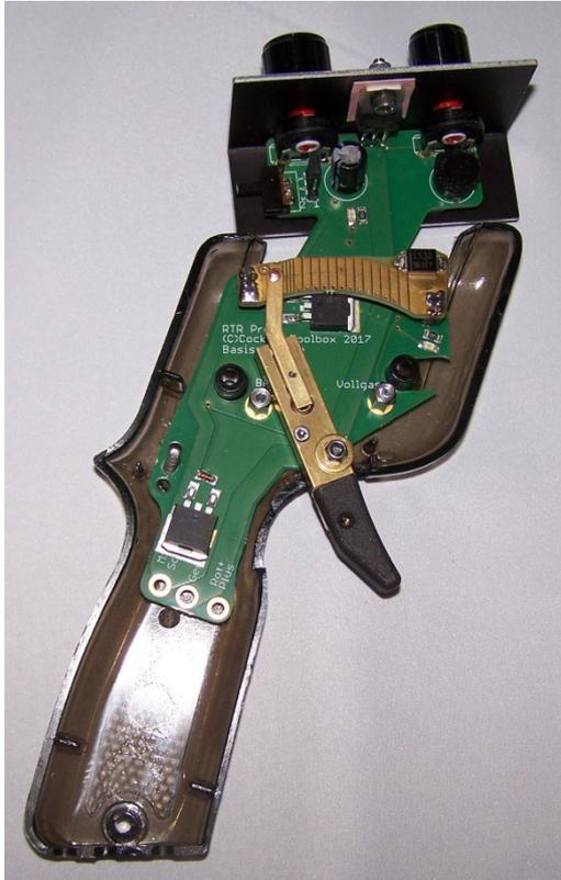
Dann die Platine einsetzen und ein 3,5mm Loch durch eines der drei linken Löcher und der Schale bohren. Auf dem Foto ist in das mittlere Loch schon die Schraube gesetzt.
