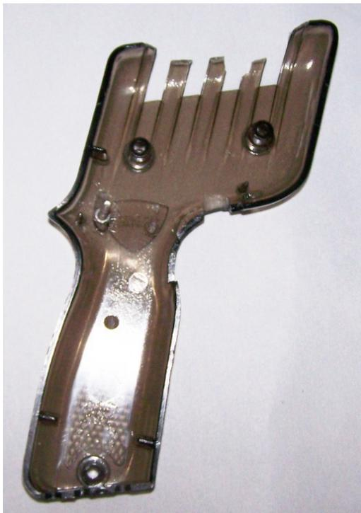
Dann die Platine aus der Schale nehmen und die Schraube durchstecken und mit einer 3mm Mutter leicht anschrauben. Evtl. das Loch in der Schale etwas vergrößern falls die Schraube nicht gerade steht und die Platine klemmt. Dann die Platine wieder zur Probe einsetzen wie auf dem Bild oben auf der Seite.
