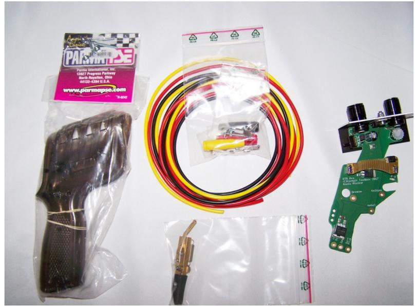
Der Bausatz, besteht aus der Hauptplatine, MCAD Hebel mit weicher Feder, Schrauben- und Kabelsatz.
